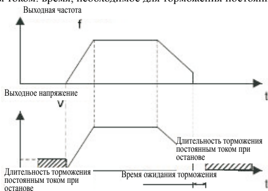
Рис. 6.3 Диаграмма торможения постоянным током
